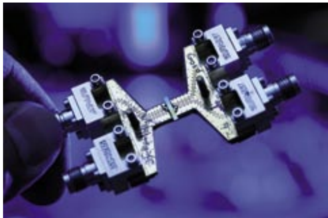
Il modulatore laser al silicio di Intel a 40 Gbps
