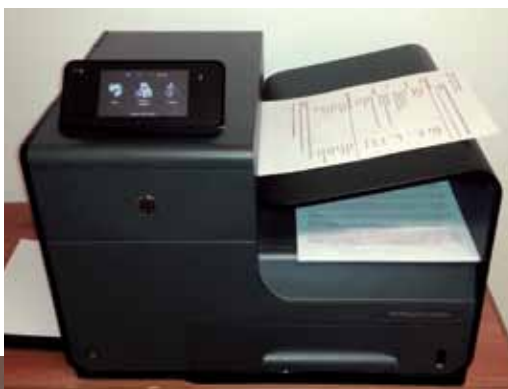
Sopra la stampante HP Officejet Pro X551dw A sinistra l'alloggiamento frontale per le cartucce d'inchiostro e a destra lo sportello laterale per l'estrazione dei fogli inceppati
