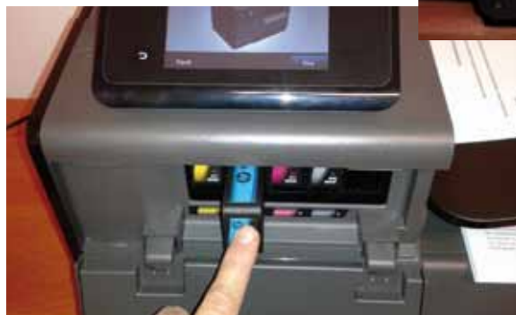
Sopra la stampante HP Officejet Pro X551dw A sinistra l'alloggiamento frontale per le cartucce d'inchiostro e a destra lo sportello laterale per l'estrazione dei fogli inceppati
