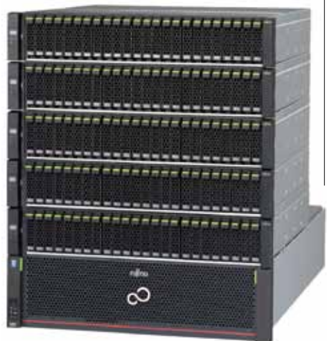
Il DX600 S3, con un massimo di 4,224 TB di storage e sino a 1.056 disk drive
