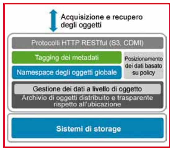
Architettura di StorageGRID Webscale
